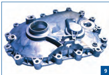
Abb. 9: Optimiertes Druckgussbauteil abgegossen in einer hochfesten Aluminium-Recyclinglegierung [2]
