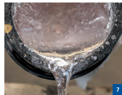
Abb. 7: Abb. 5: Schwerkraftgießen mit Aluminium Schmelze, Foto: Fraunhofer IGCV / Andreas Heddergott
