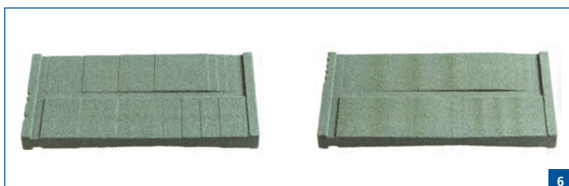
Abb. 6: Behebung des Treppenstufeneffektes durch geometrieabhängige Binderverteilung, Foto: Fraunhofer IGCV
