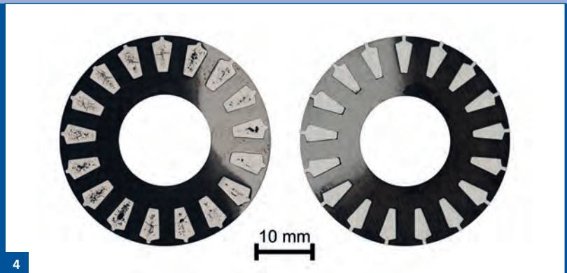
Abb. 4: Querschnitt der gegossenen Seriengeometrie mittig durch die Stäbe des Kurzschlusskäfigs, links: druckgegossen, rechts: niederdruckgegossen, Foto: utg
