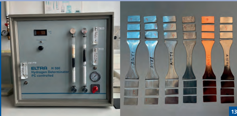
Abb. 13: (links) Heißgaßextraktions-Messgerät; (rechts) Versuchsproben zur Bestimmung des diffusibelen Wasserstoffanteils an jeder Reinigungs- und Beschichtungsfolge
