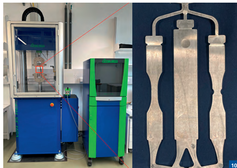
Abb. 10: (links) Servohydraulische Schwingprüfanlage Fa. Dyna-Mess; (rechts) Probengeometrie für ungekerbte und mild gekerbte Flachproben
