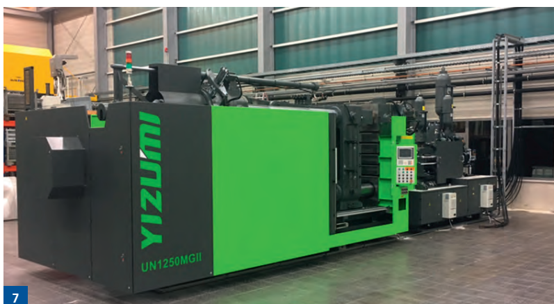
Abb. 7: Auf der vollautomatischen Thixomolding-Druckgießzelle mit einer Schließkraft von 12.500 kN soll ein neuartiges Raucherfassungssystem integriert und erprobt werden (Quelle: GTK)
