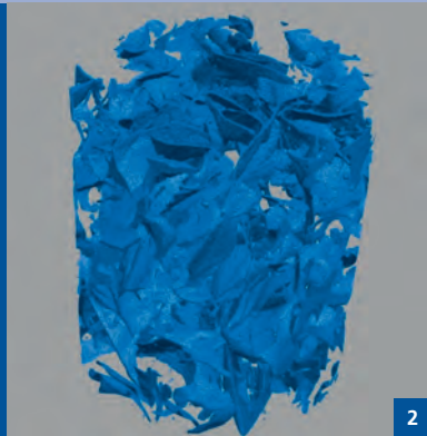
Abb. 2: n-CT-Tomographie eines groben A-Graphit Netzwerks.
